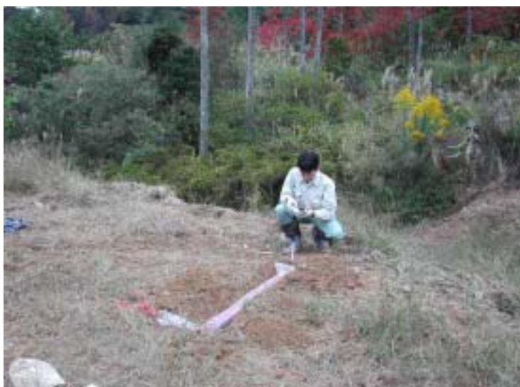
MT-7 水平コイル埋め込み
