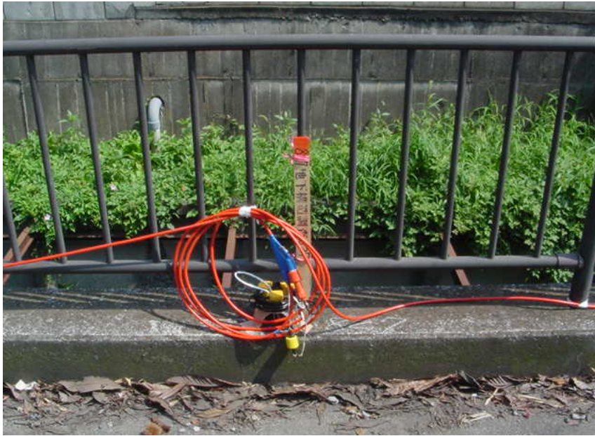
Line-2 受振器設置状況
