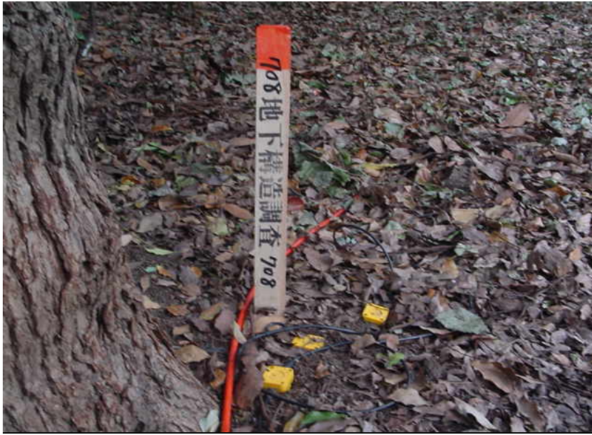
Line-2 受振器設置状況
