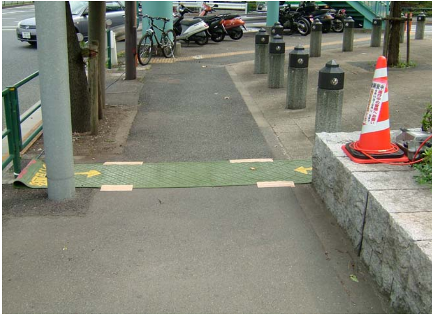
Line-2 受振器設置状況
