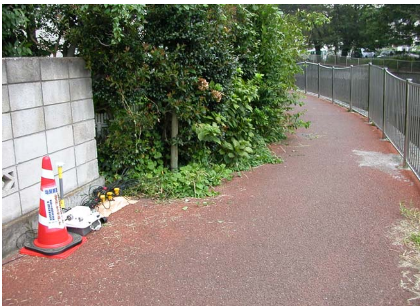
MS-2000 Line 受振器設置状況
