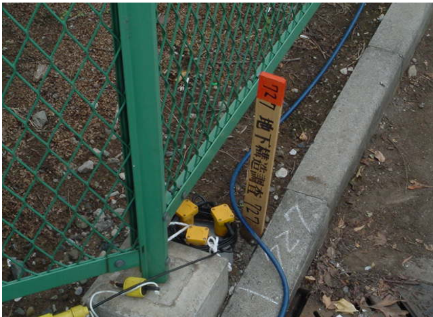
Line-2 受振器設置状況
