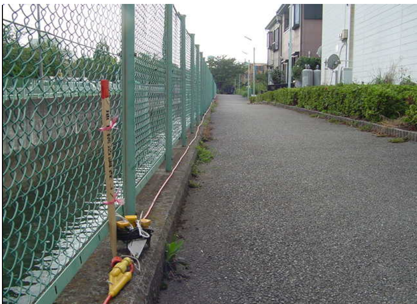
Line-1 受振器設置状況 RP31 白子川緑道沿い(2)
