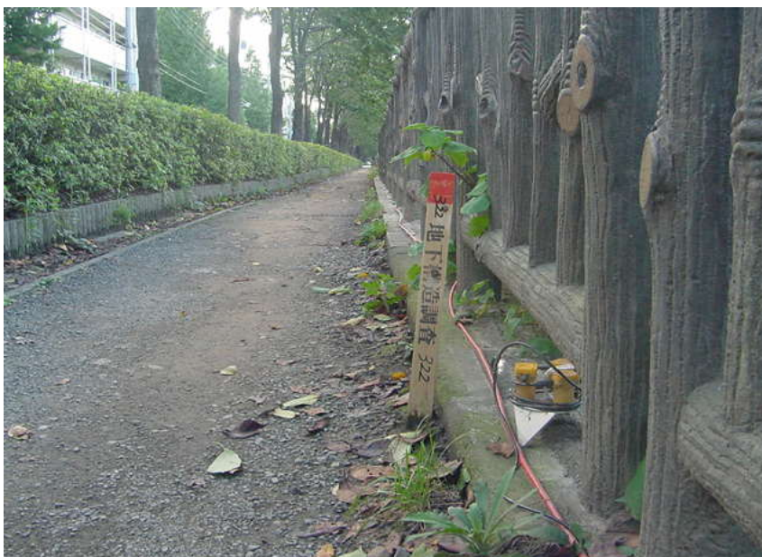
Line-1 受振器設置状況
