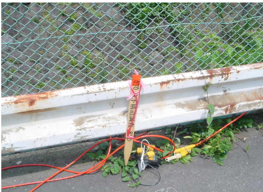
Line-2 受振器設置状況
