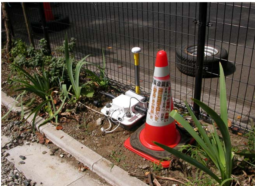
MS-2000 Line 受振器設置状況
