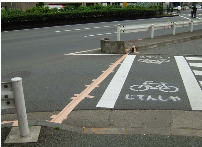
Line-2 受振器設置状況
