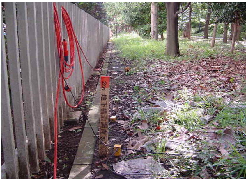
Line-1 受振器設置状況
