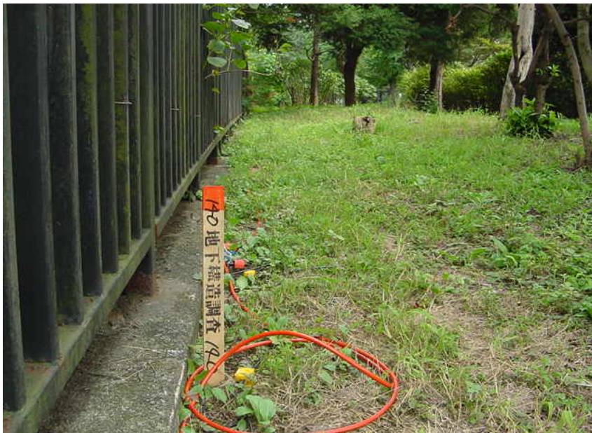
Line-1 受振器設置状況
