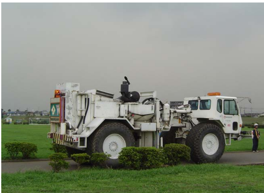
バイブロサイズ発震状況 多摩川河川敷
