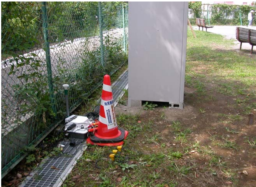
MS-2000 Line 受振器設置状況
