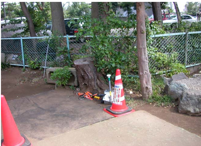
MS-2000 Line 受振器設置状況
