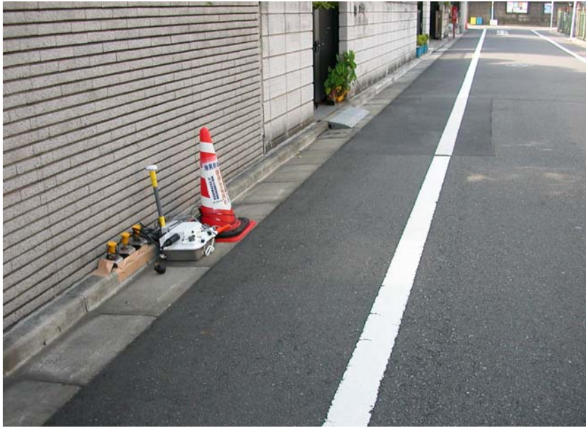
MS-2000 Line 受振器設置状況
