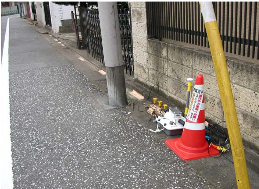
MS-2000 Line 受振器設置状況
