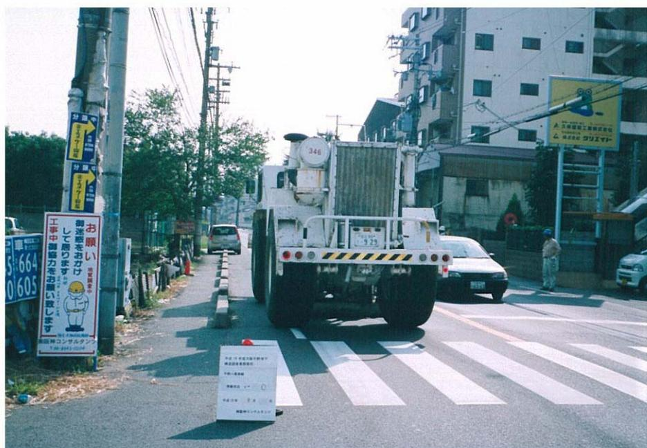
写真-9 CMP1 付近におけるバイブレータによる発震状況(測点 0 付近)
