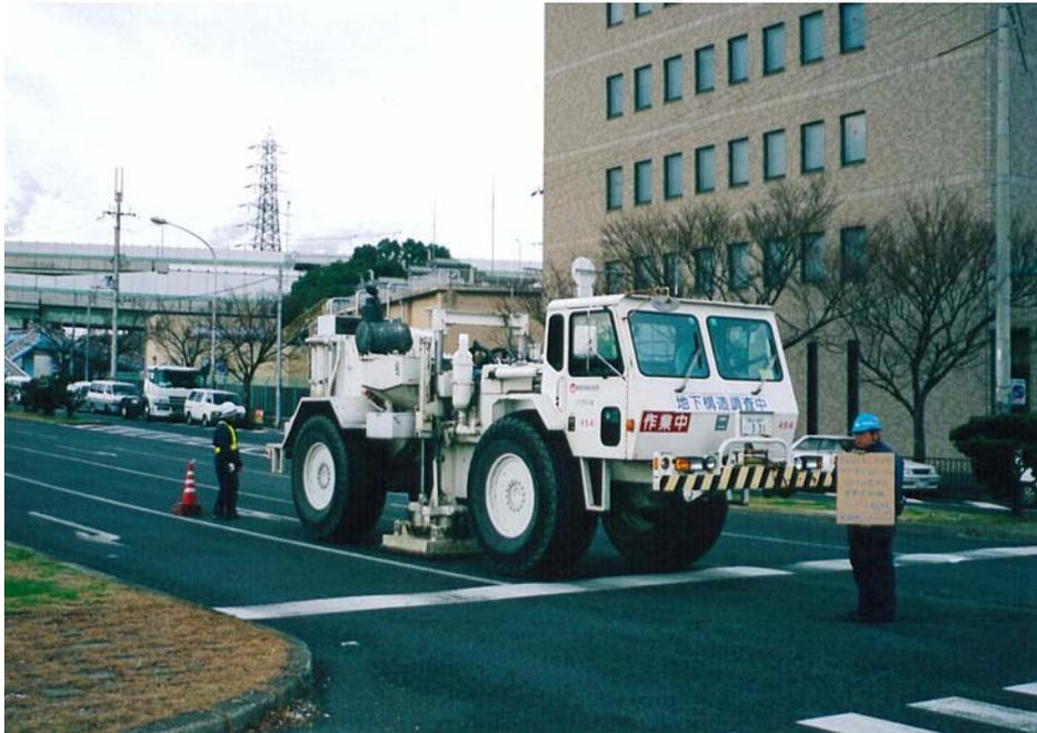
写真-35 CMP397 付近におけるバイブレータによる発震状況(測点 405 付近)
