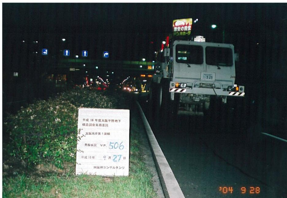
写真-25 CMP1780 付近におけるバイブレータによる発振状況(測点 1029 付近)
