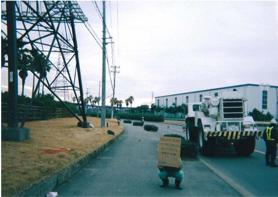
写真-33 CMP1 付近におけるバイブレータによる発震状況(測点 195 付近)
