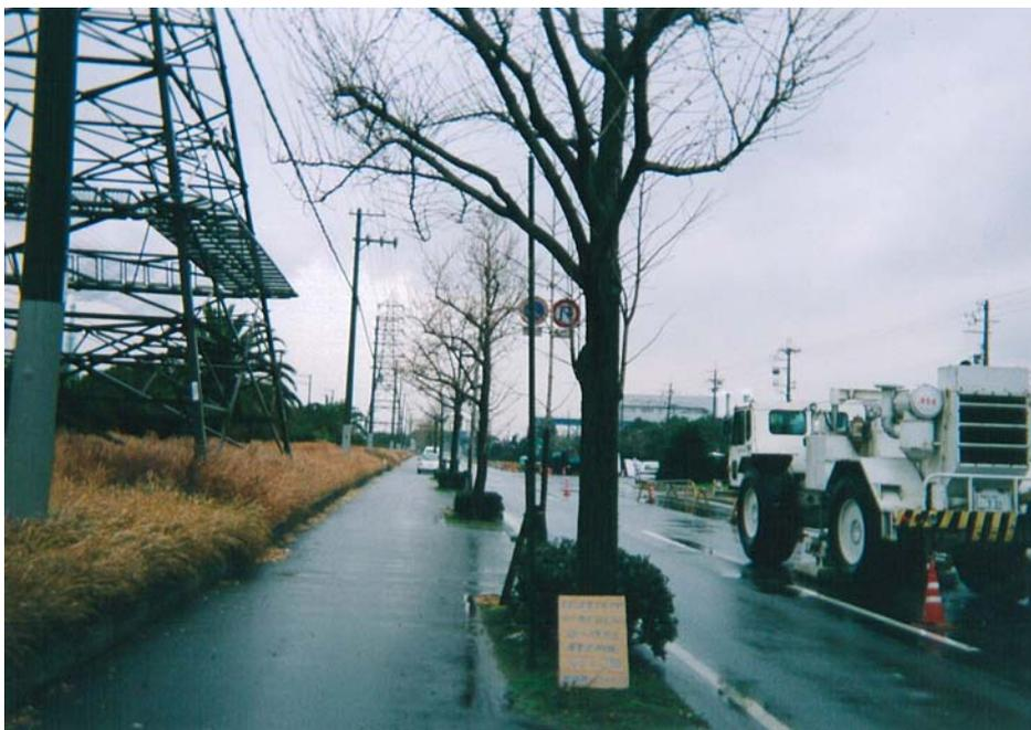
写真-34 CMP170 付近におけるバイブレータによる発震状況(測点 290 付近)
