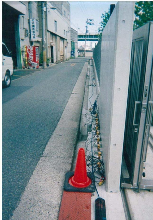
写真-20 地震計設置状況（アスファルト舗装部）
