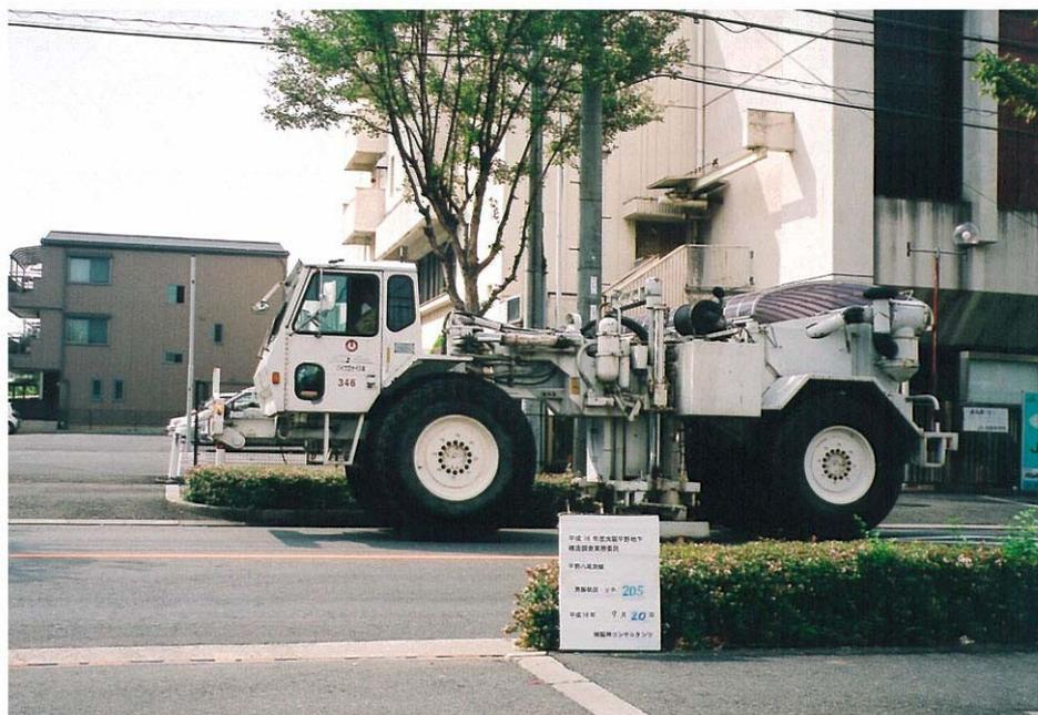
写真－11 CMP390 付近におけるバイブレータによる発震状況(測点 205 付近)
