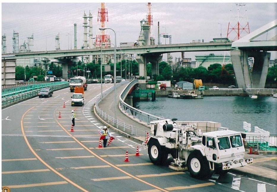
写真-23 CMP1030 付近におけるバイブレータによる発震状況(測点 596 付近)
