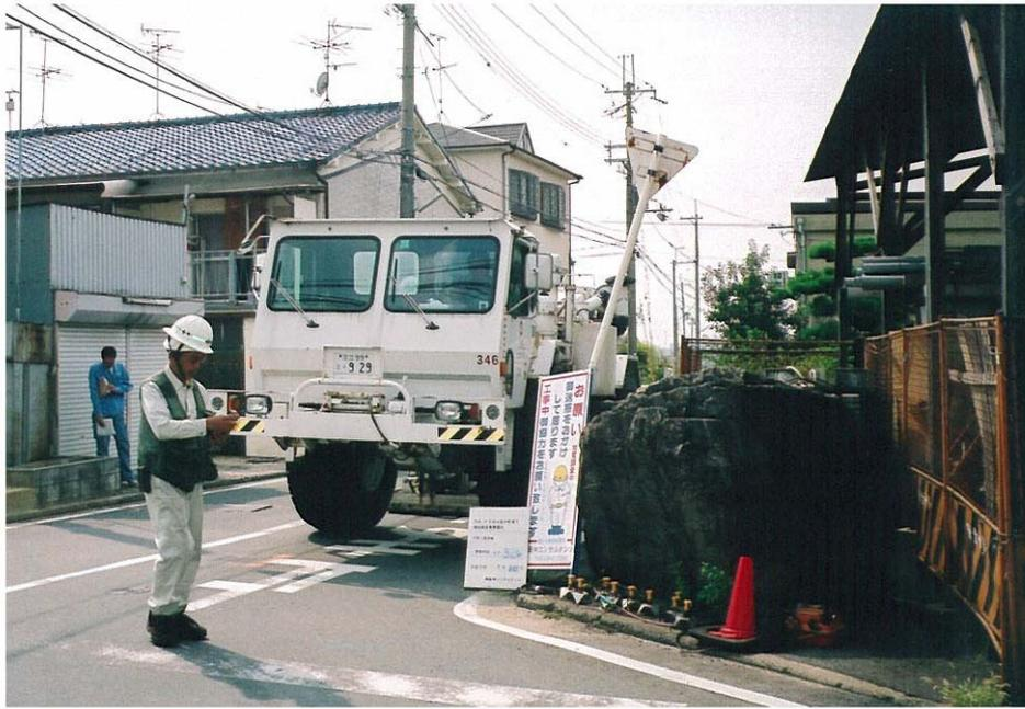
写真-13 CMP614 付近におけるインパクトによる発震状況(測点 324 付近)
