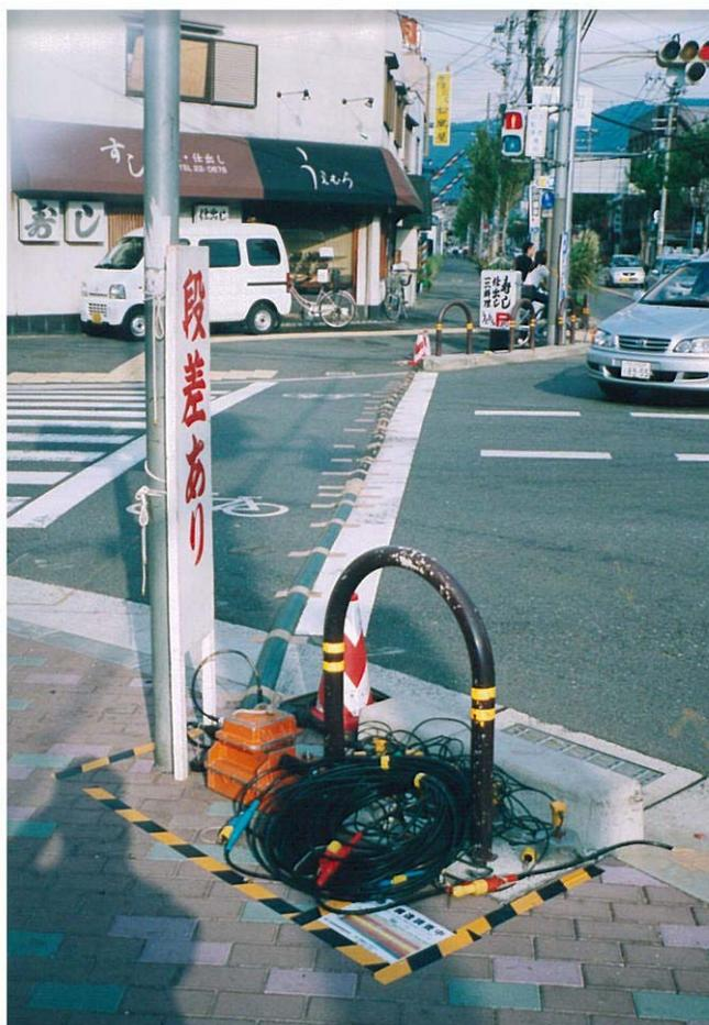
写真-1 受振器材設置状況
