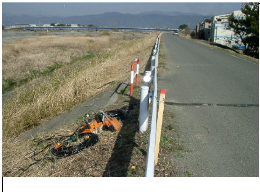
受振器設置状況 B測線RP 176
