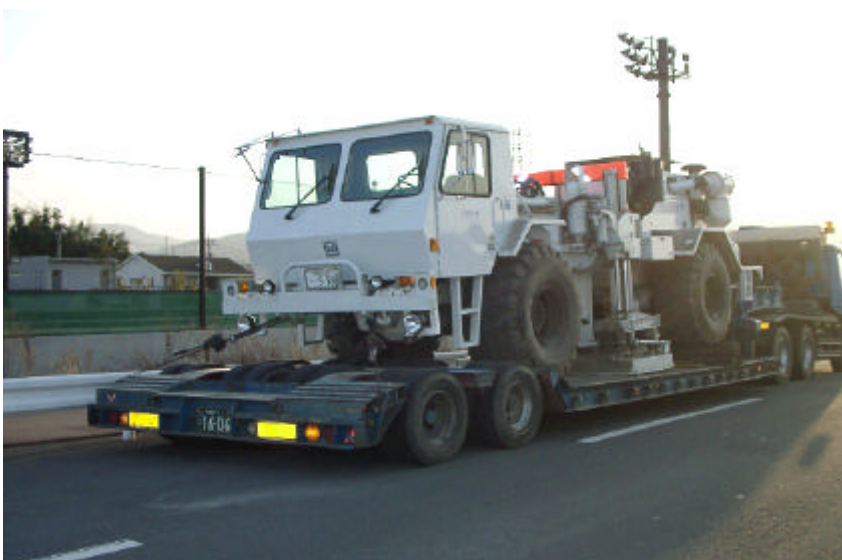
パイプロサイス搬出風景
