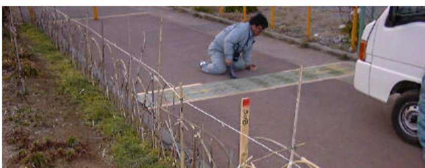
受振器設置状況 A測線RP508
