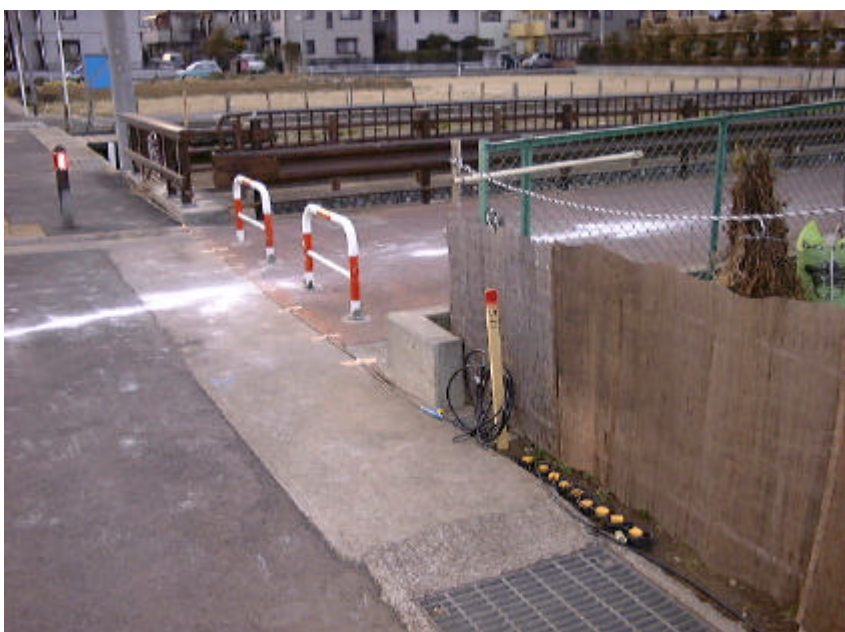
受振器設置状況 A測線RP511
