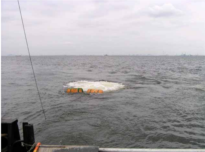
エアガン発振状況 1500cu.in.、2000psi
