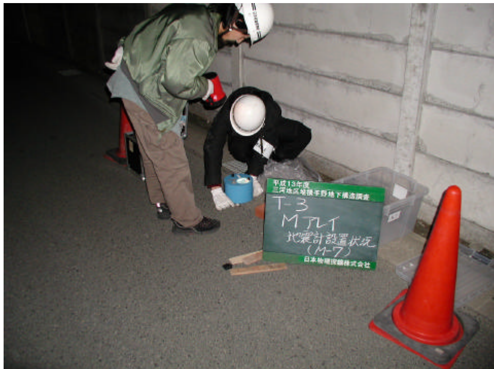
地震計設置状況 ( T - 3 Mアレー(M-7) )
