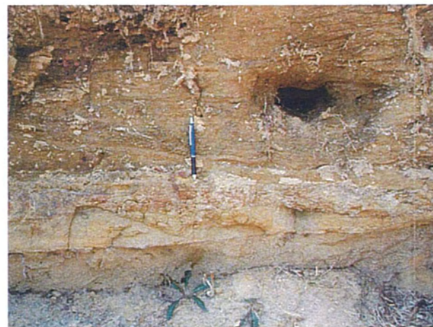
写真-2 多摩丘陵部で上総層上位を被覆する砂層（下位と砂質シルト層）
