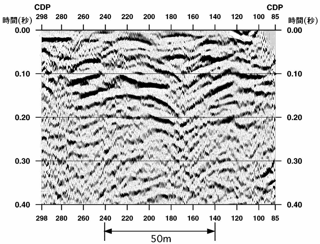
图 2-2-8 重合断面图 (長井市平山地区:S波)
