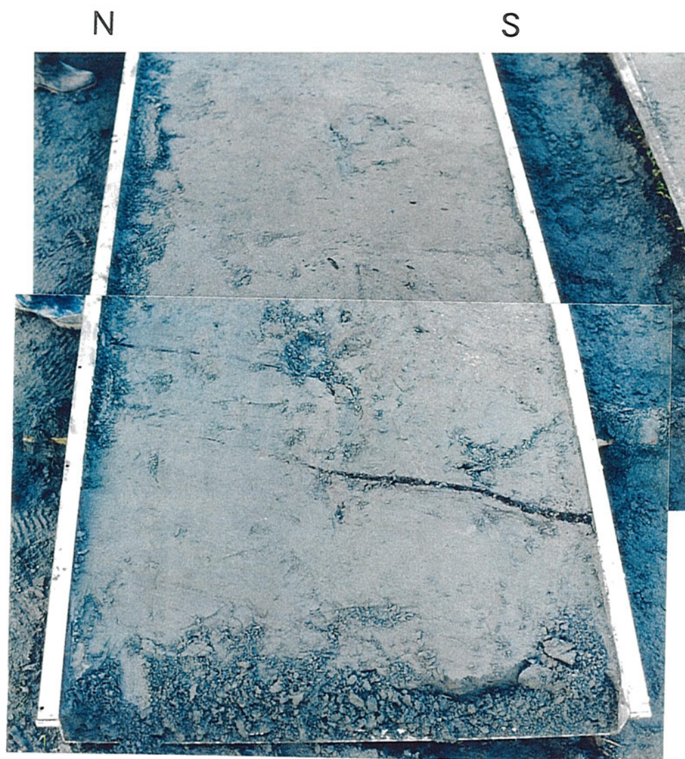
写真－ 17 Geo-Slicer で採取した試料. Geo-Slicer は幅 1.1 m で長さ (深さ) は 4 m である. 写真左側が北で, 右側が南である. トレンチから下位には砂層が分布している. 下部はラミナが顕著で約 10^{\circ} 南側に傾斜している. 黒い部分は材密集層.
