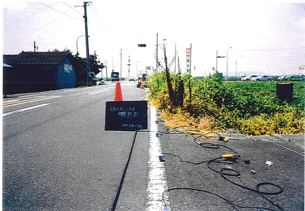
浅層反射法弾性波探査 姫田地区の測線状況
