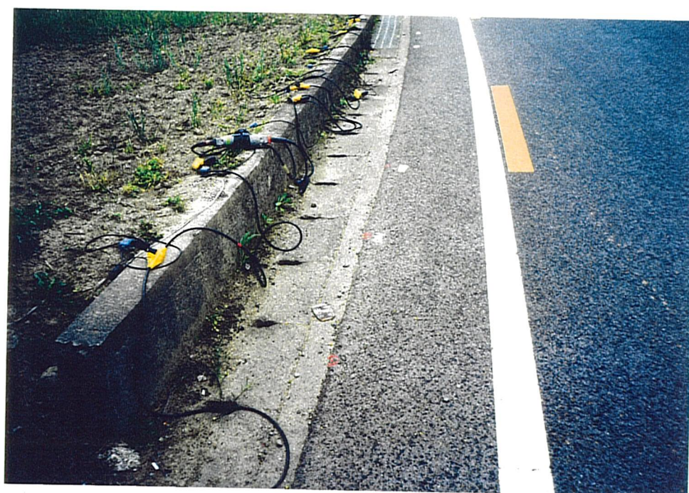
浅層反射法弾性波探査 川端地区の地震計設置状況
