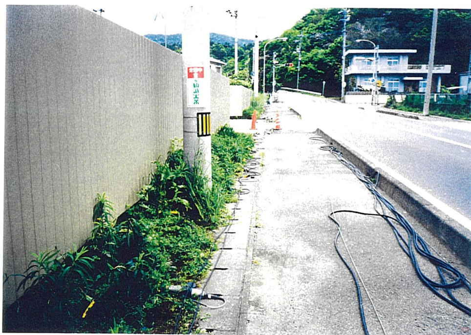
浅層反射法弾性波探査 川端地区の測線状況
