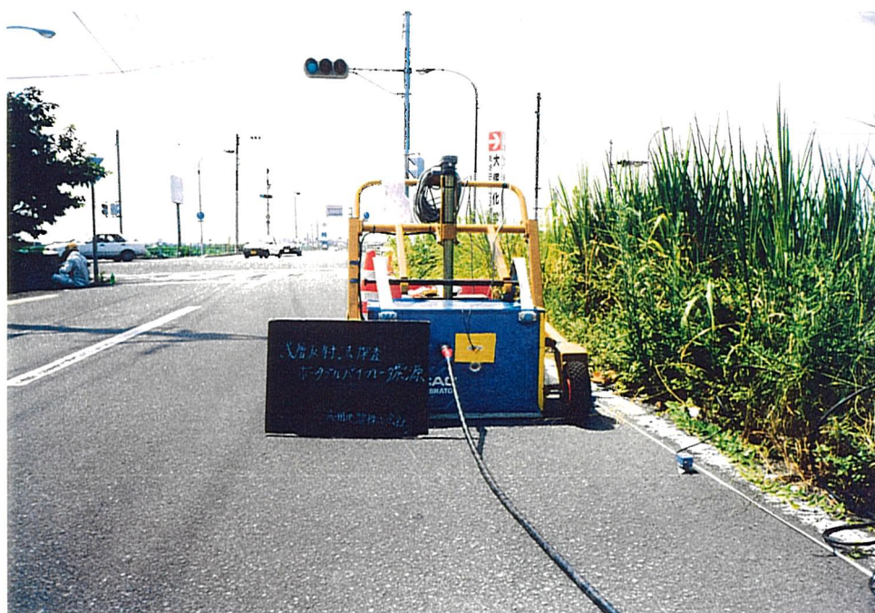
浅層反射法弾性波探査 姫田地区の震源及び受振器
