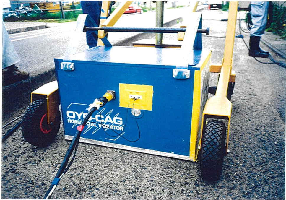
浅層反射法弾性波探査 川端地区の震源
