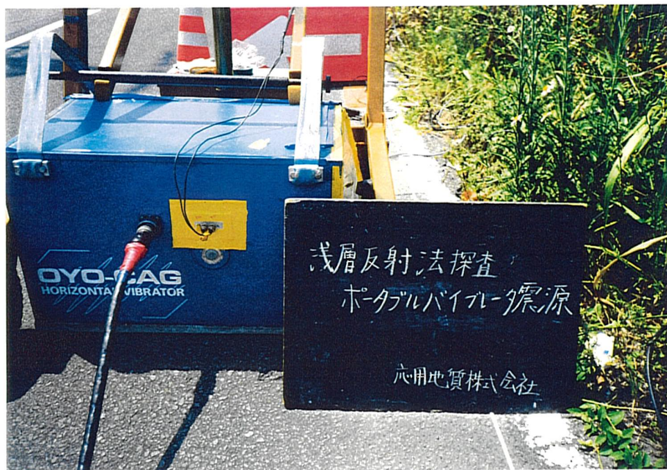
浅層反射法弾性波探査 姫田地区の震源
