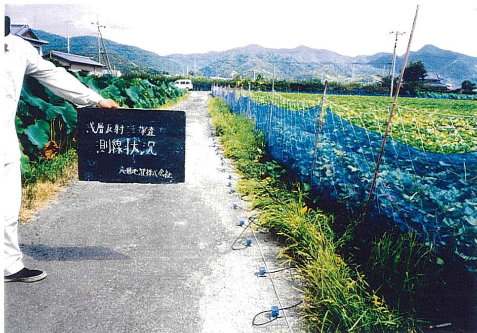
浅層反射法弾性波探査 段関・大代地区の測線状況
