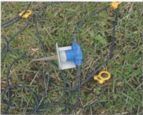
受振器設置状況
