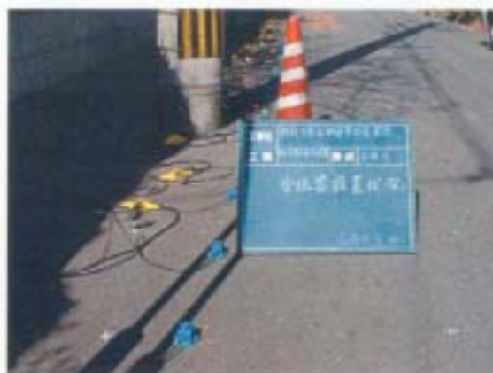
受振器設置状況
