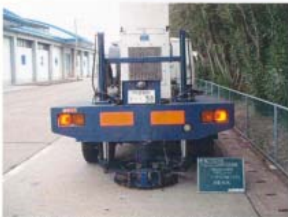
道路測線ミニバイブ起震状況(P波)
