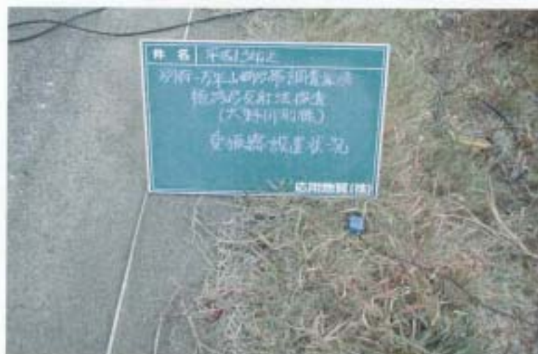
受振器設置状況・大野川測線
