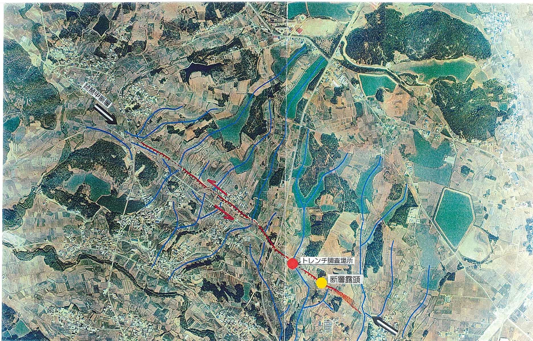
図 4.1.1 琵琶甲断層にそって追跡される断層変位地形と断層露頭、トレンチ位置 (加西市琵琶甲町付近)
