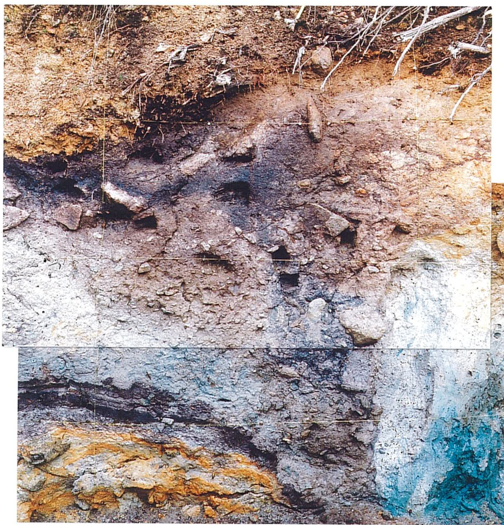
写真6-14 No. 4 (H12-1) トレンチNE面の断層
