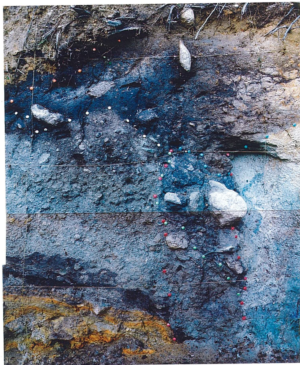
写真6-15 No. 4 (H12-2) トレンチNE面の断層
