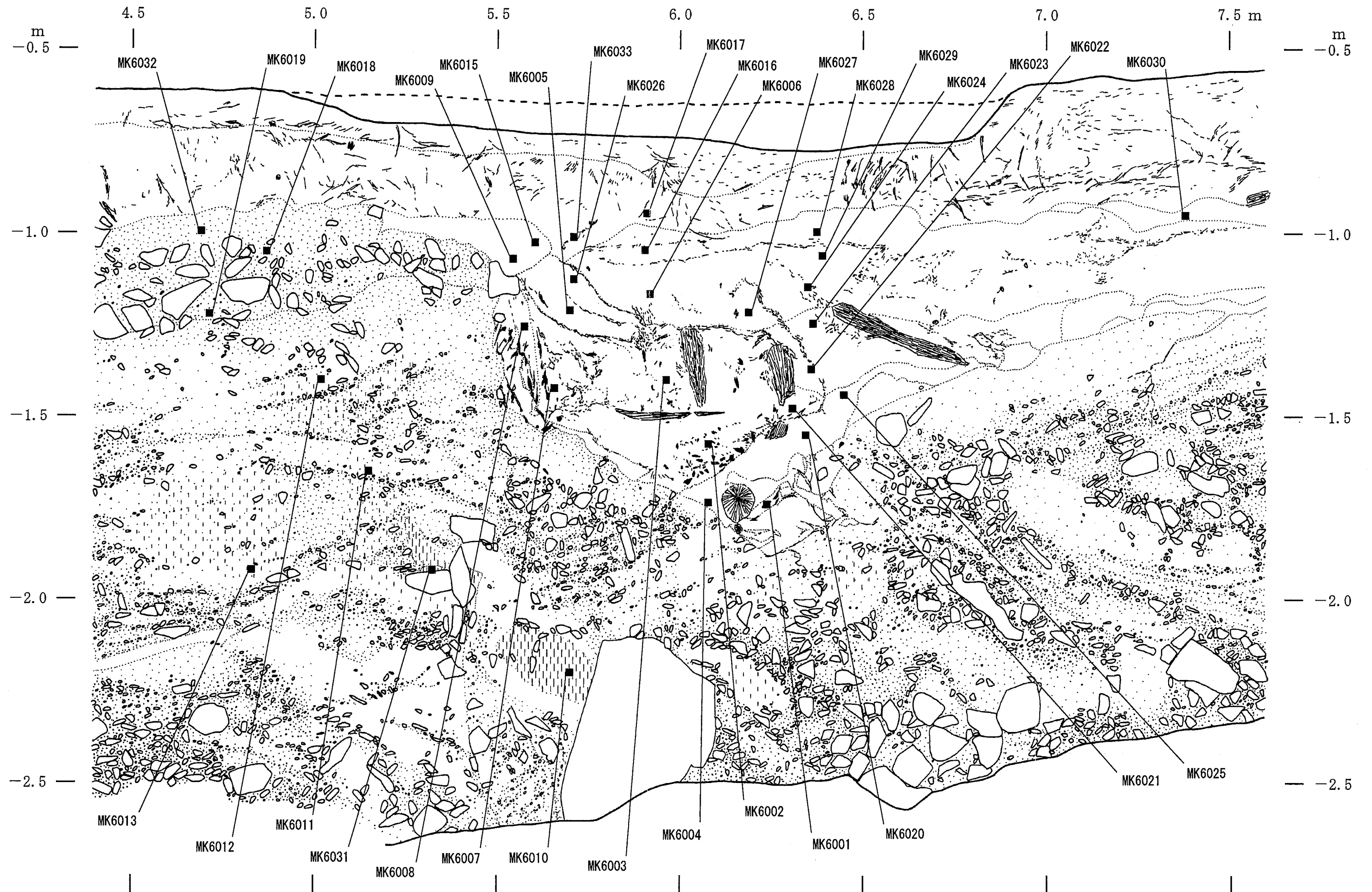
図6-6-1 No. 1 (H12-1) トレンチSW面スケッチ (兼年代測定用試料採取位置図)
