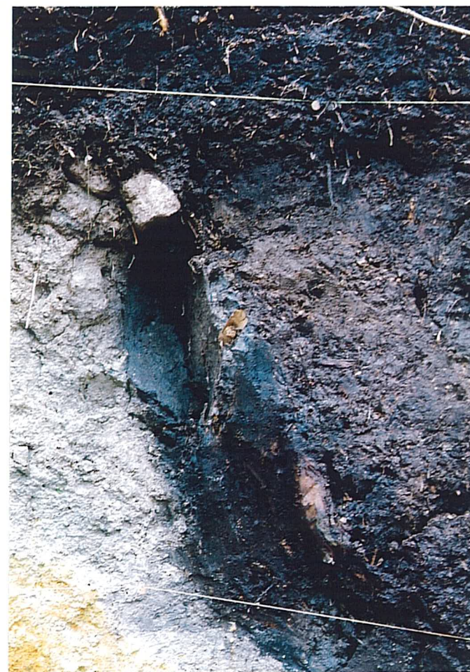
写真6-7 No. 1 (H12-2) トレンチSW面 ほぼ垂直に変形している1C-3層
