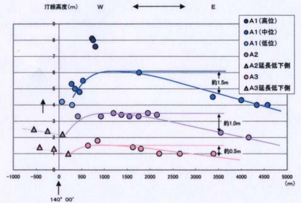
図 6-3-3 断層による隆起と海水準の変化に伴う汀線上昇の概念図
