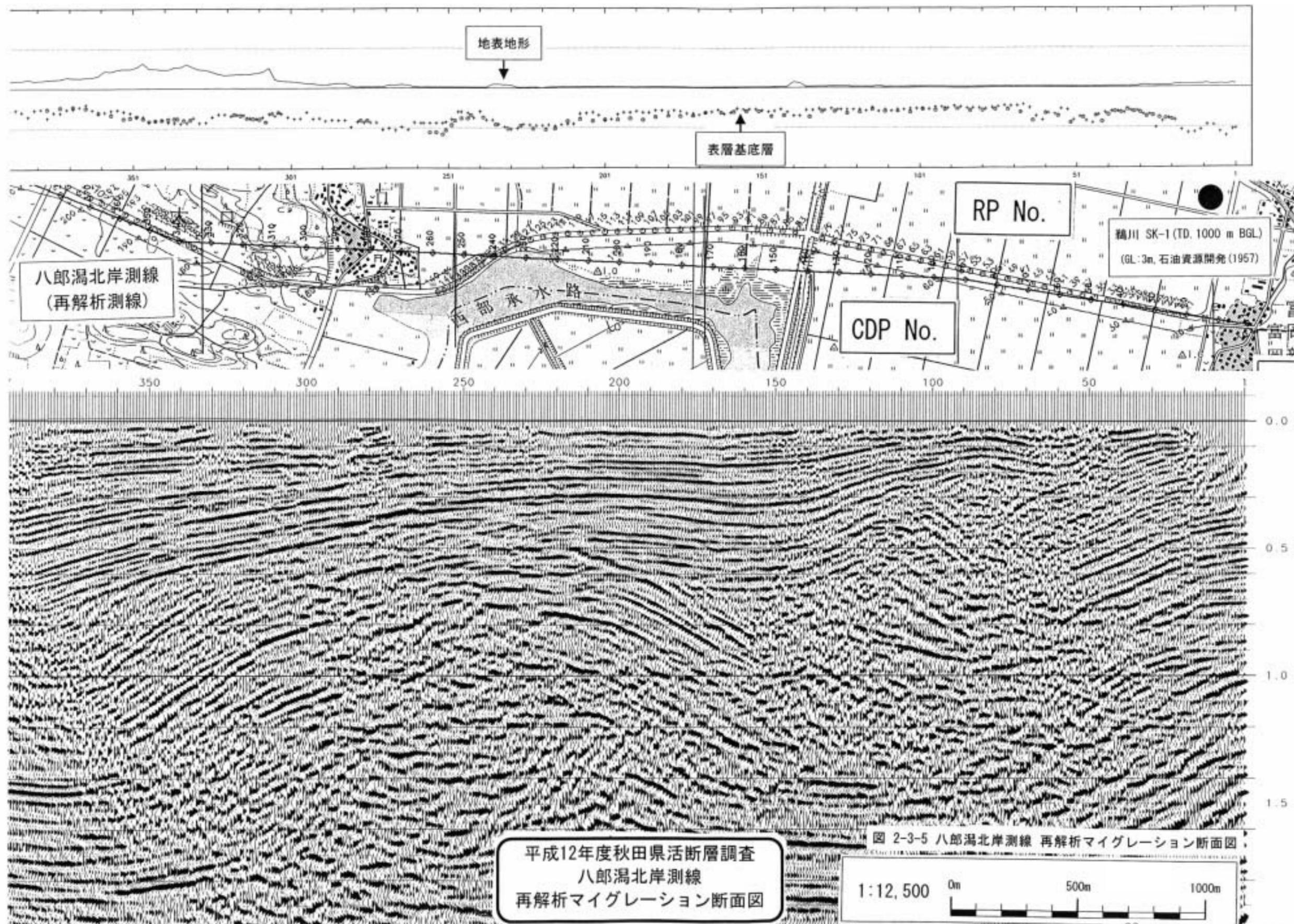
図 2-3-5 八郎潟北岸測線 再解析マイグレーション断面図
